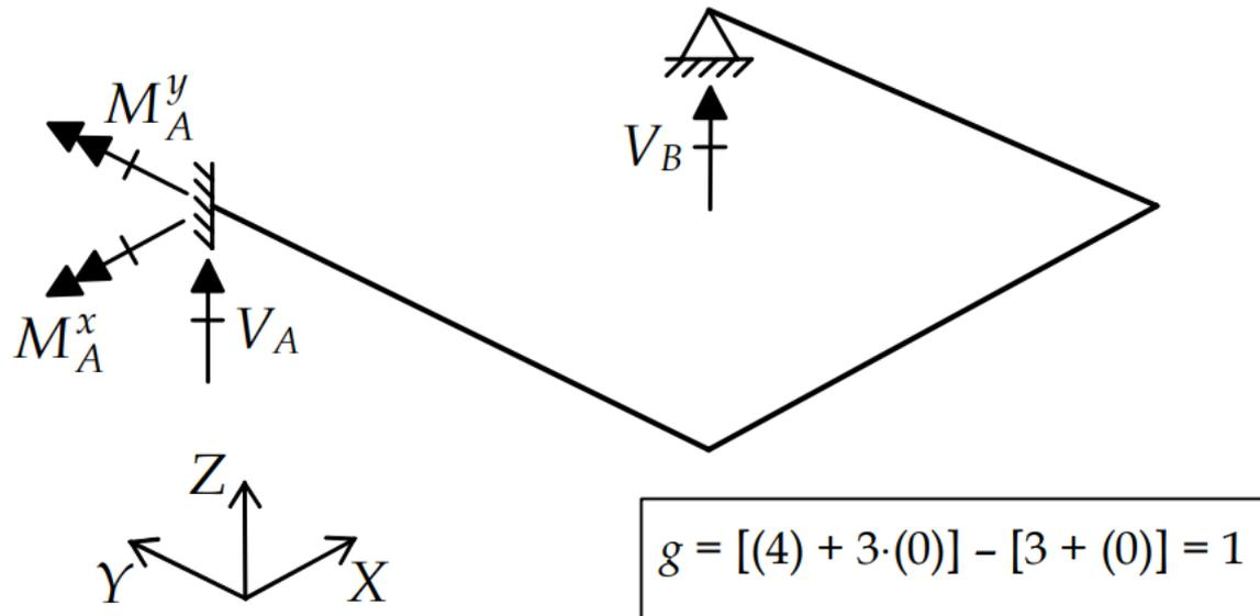
Figura 2.24 – Exemplo de determinação do grau de hiperestaticidade de grelha.
