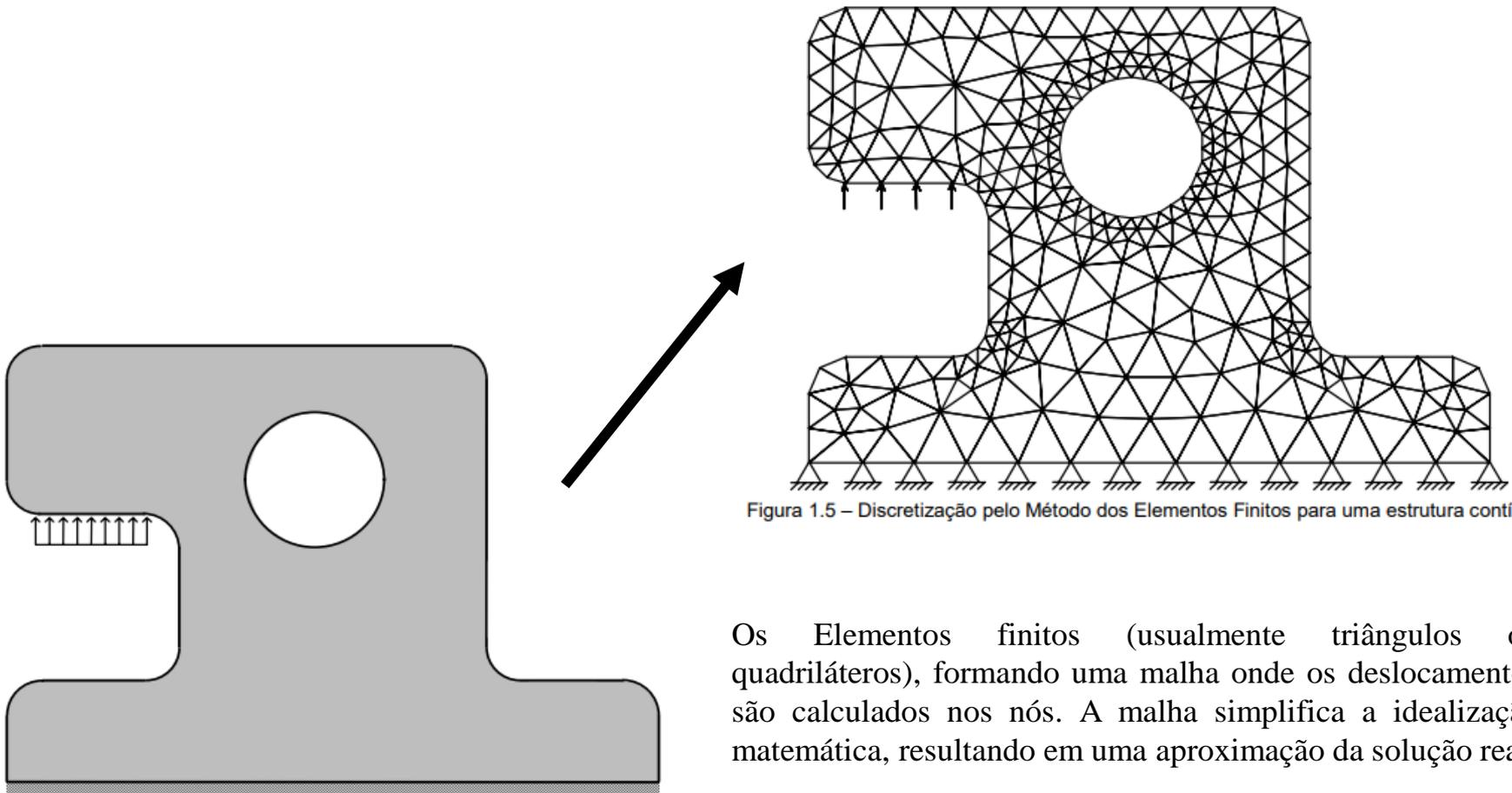
Figura 1.5 – Discretização pelo Método dos Elementos Finitos para uma estrutura contínua.
