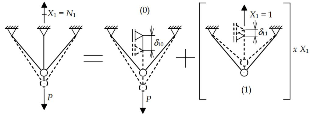
Figura 2.9 – Superposição de soluções básicas do Método das Forças.
