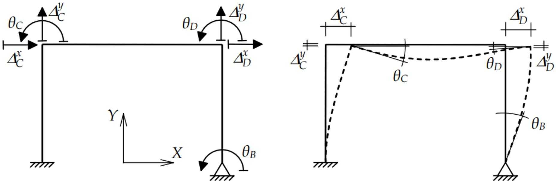
Figura 1.4 – Parâmetros nodais utilizados na discretização pelo Método dos Deslocamentos.
