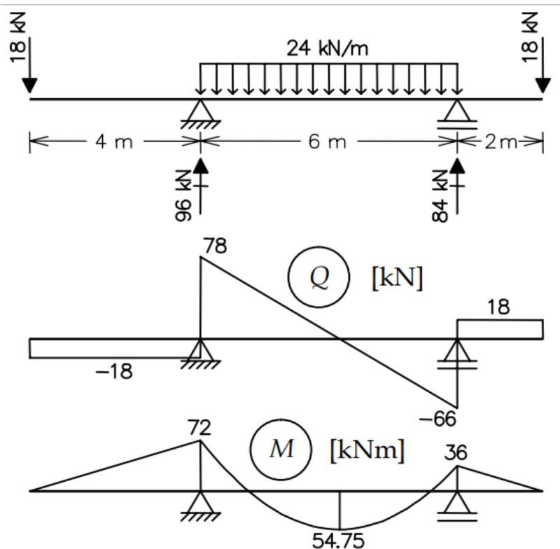
Figura 4.1 – Viga biapoiada com balanços.
