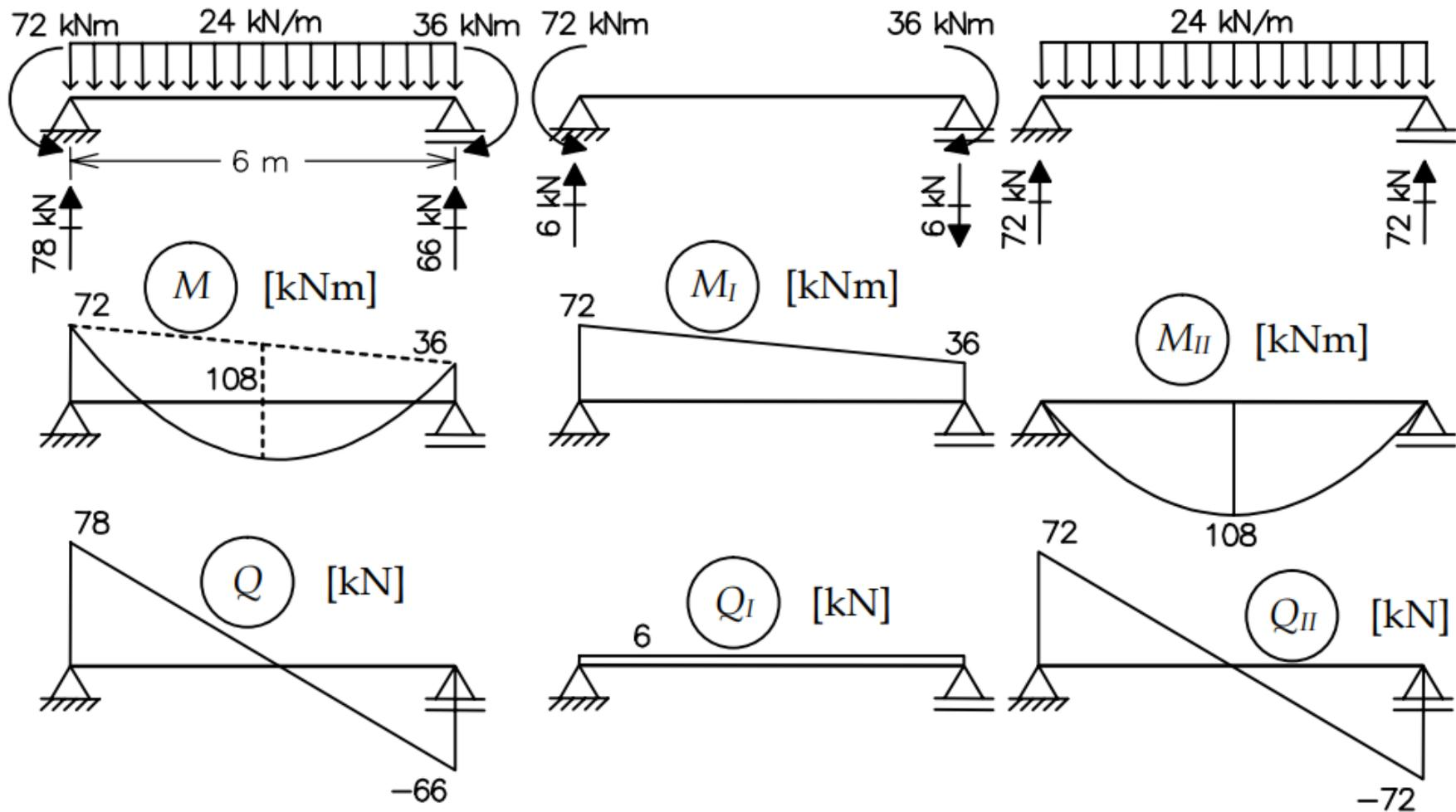
Figura 4.5 – Traçado do diagrama de esforços cortantes a partir do diagrama de momentos fletores.
