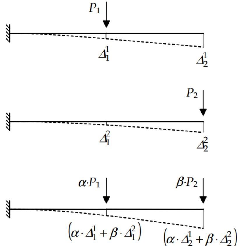
Figura 2.11 – Combinação linear de duas forças e os correspondentes deslocamentos.
