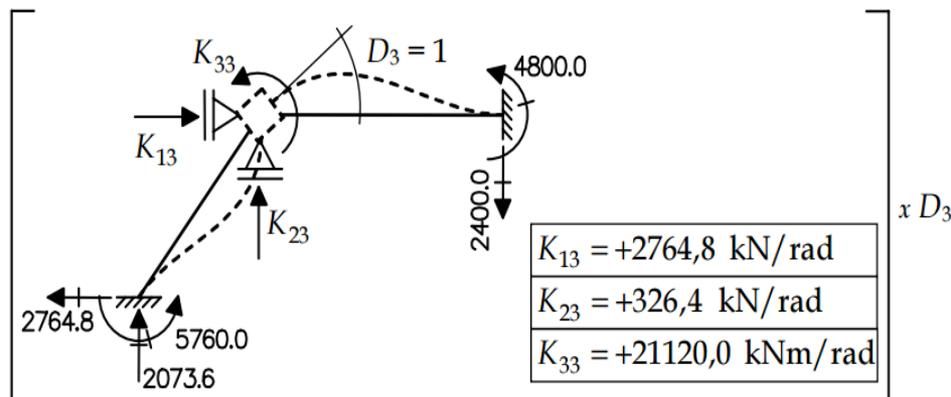
Figura 6.8 – Deslocabilidade  $D_3$  isolada no SH da estrutura da Figura 6.3.
