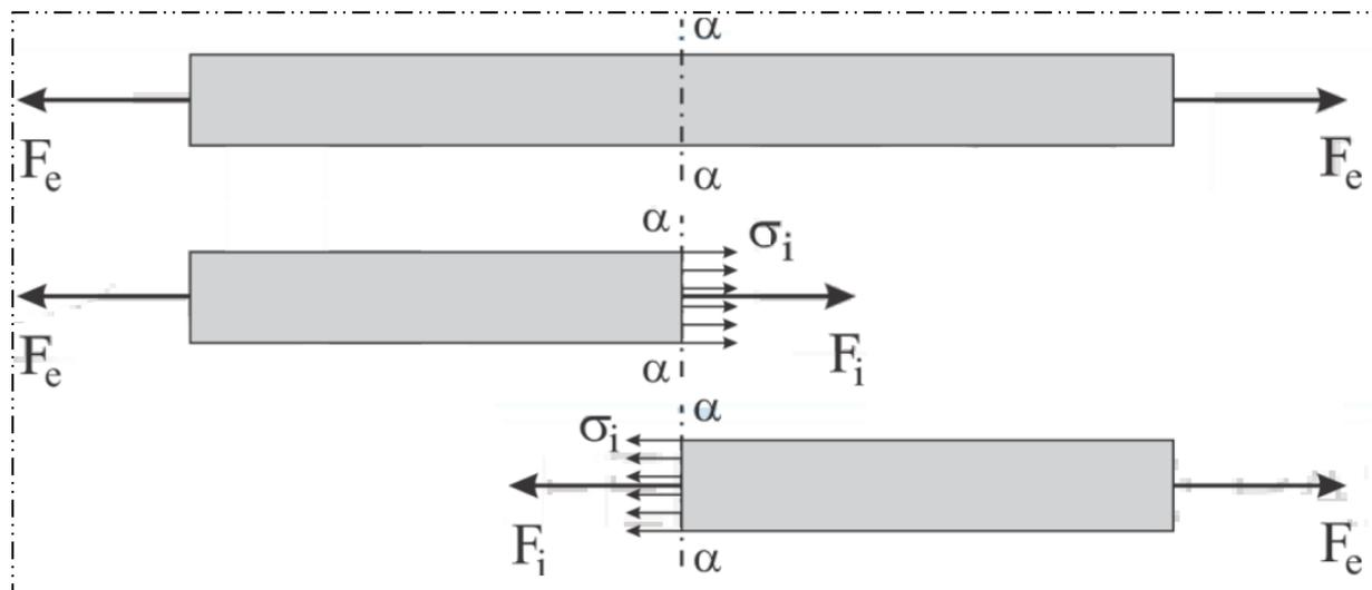
Diagrama de corpo livre ilustrando as tensões internas e os esforços internos normais.
