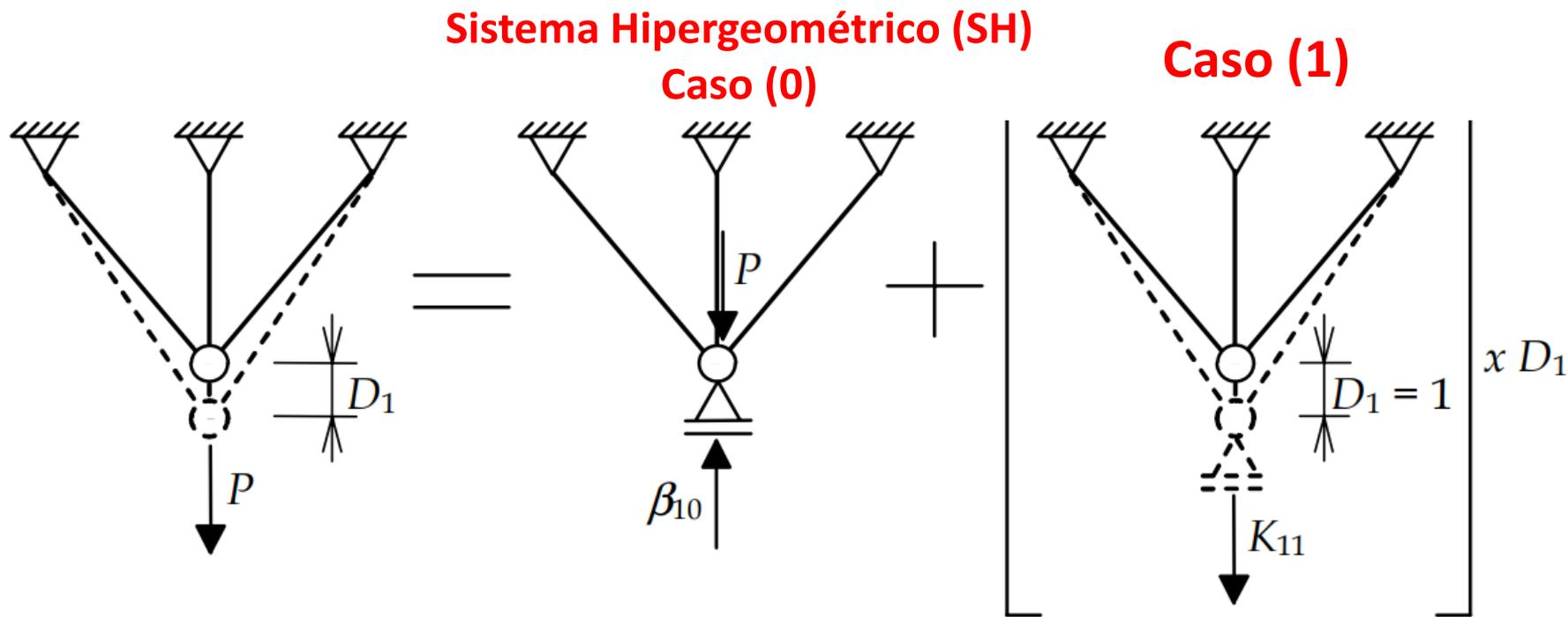
Figura 2.10 – Superposição de soluções básicas do Método dos Deslocamentos.
