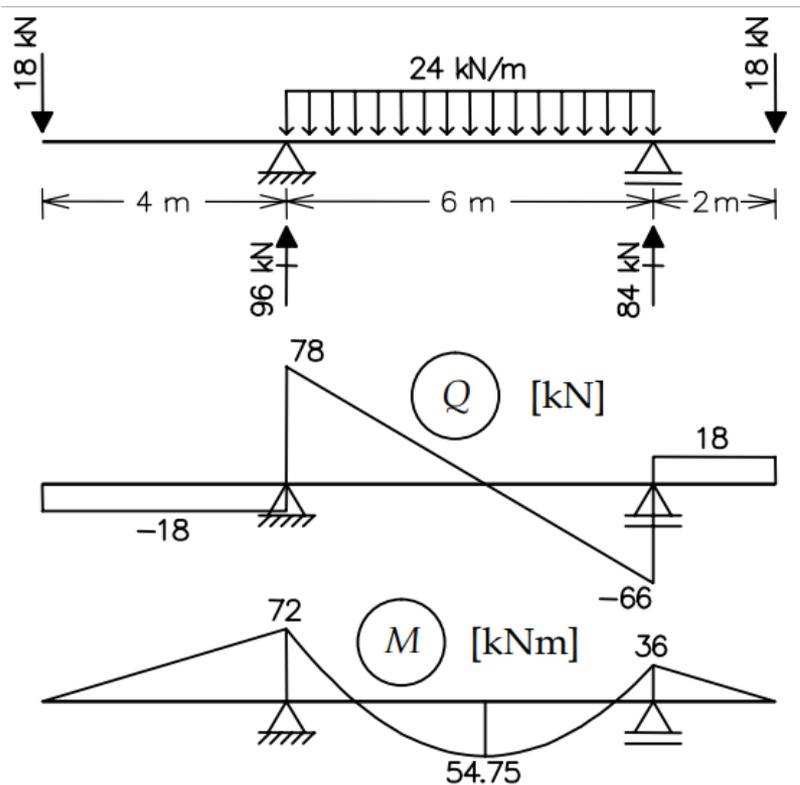
Figura 4.1 – Viga biapoiada com balanços.
