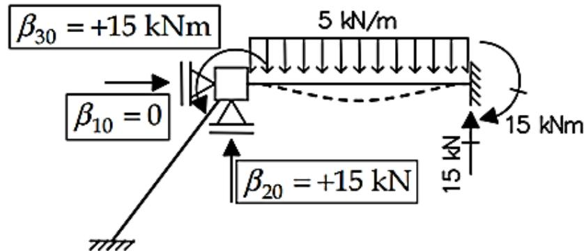
Figura 6.5 – Solicitação externa isolada no SH da estrutura da Figura 6.3.
