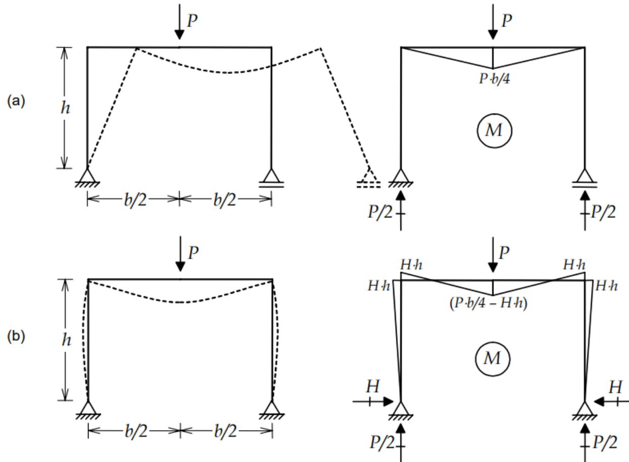
Figura 2.17 – Quadros isostático (a) e hiperestático (b), configurações deformadas, reações de apoio e diagramas de momentos fletores.<sup>1</sup>
