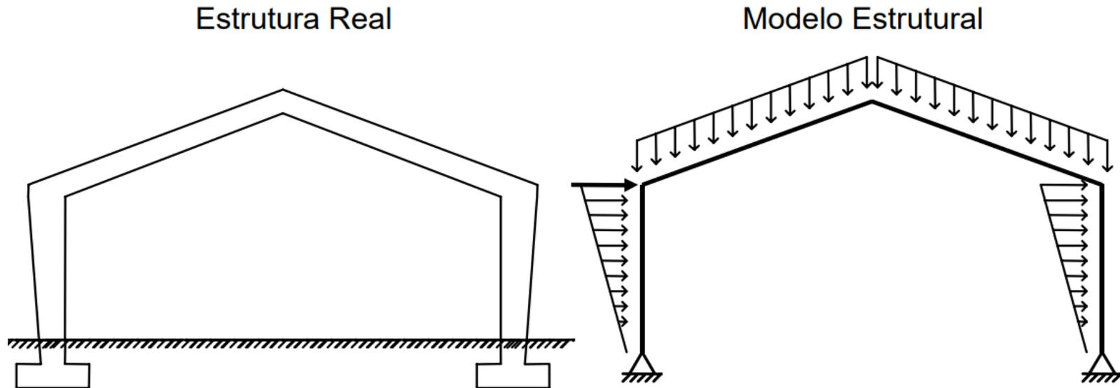
Figura 1.2 – Estrutura real e o seu modelo estrutural.
