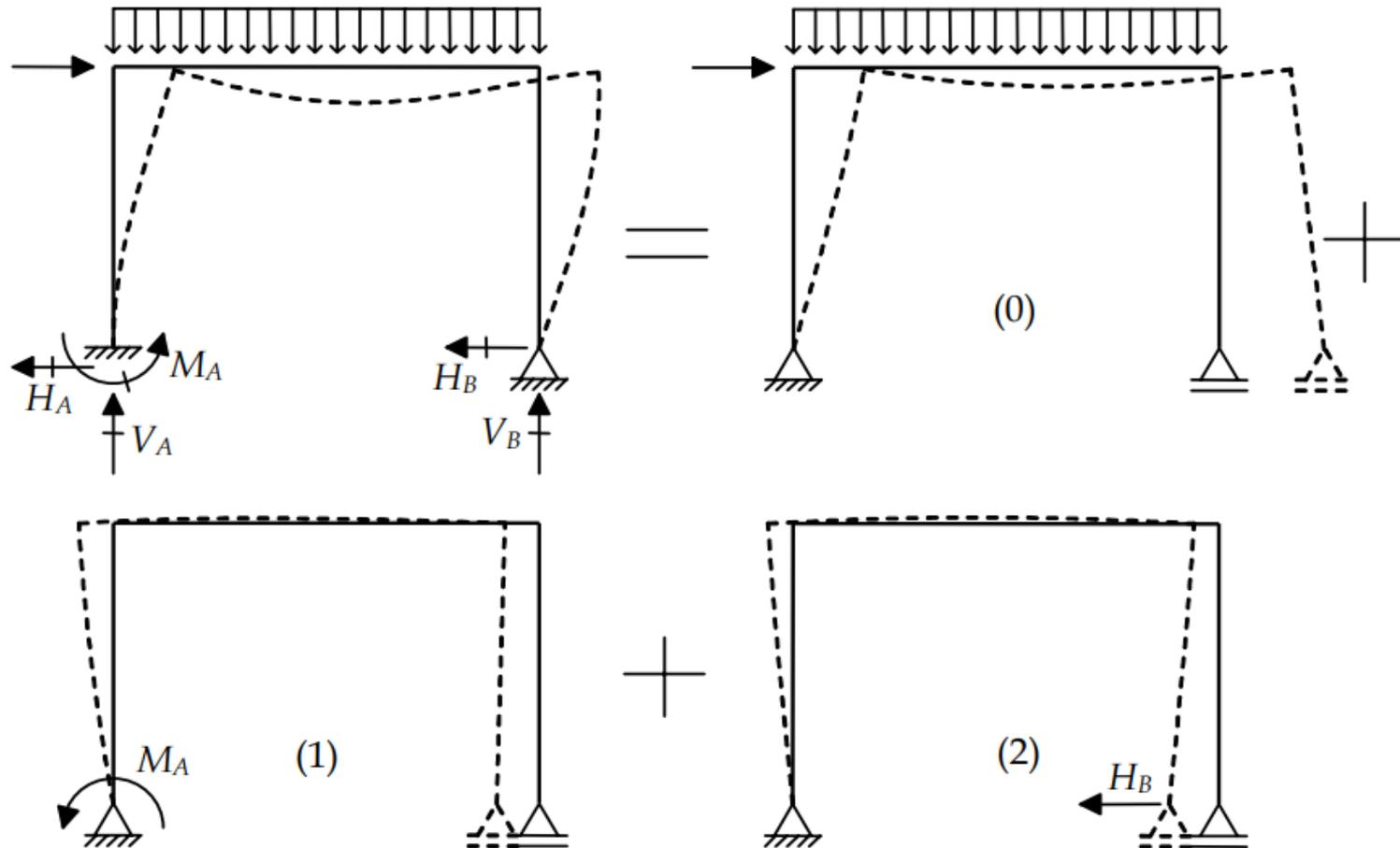
Figura 1.3 – Superposição de soluções básicas no Método das Forças.
