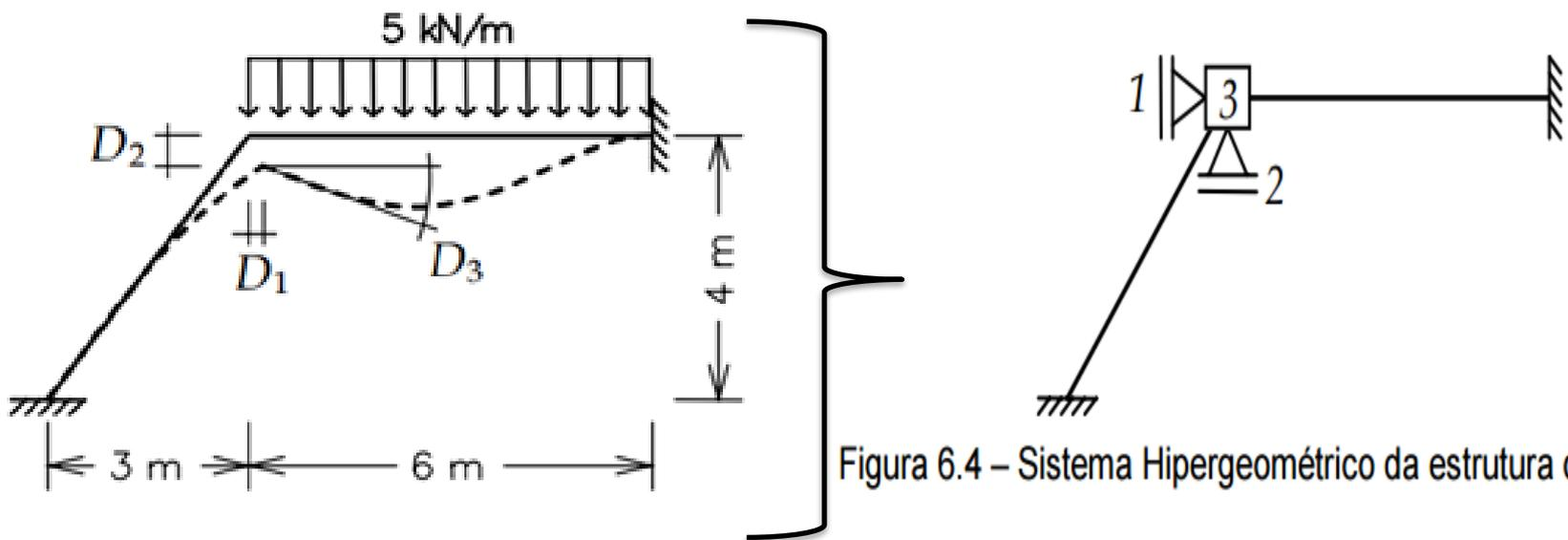
Figura 6.4 – Sistema Hipergeométrico da estrutura da Figura 6.3.
