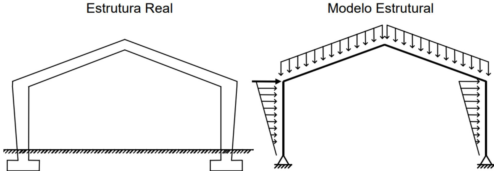
**Hipóteses considerada no modelo:**  $\epsilon = d/L$ ; lei de Hooke; carga permanente, carga variável; condições de apoio: segundo gênero; etc.
