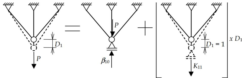
Figura 2.10 – Superposição de soluções básicas do Método dos Deslocamentos.
