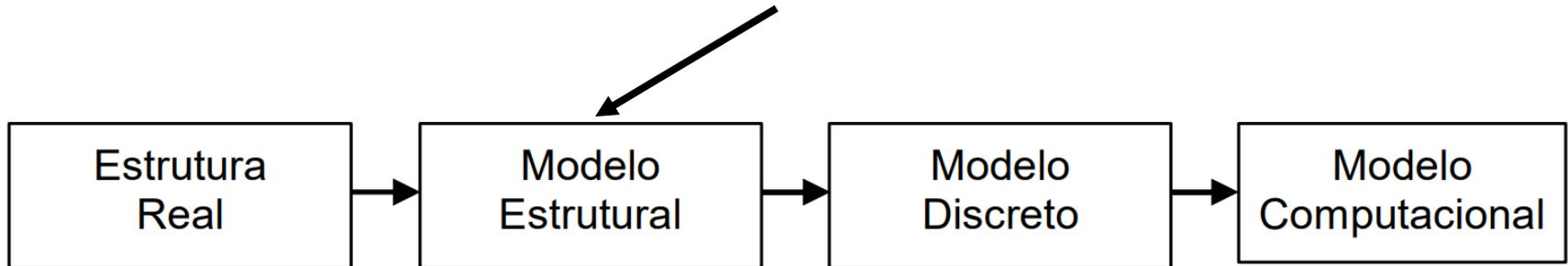
Figura 1.1 – Quatro níveis de abstração para uma estrutura na análise estrutural.
