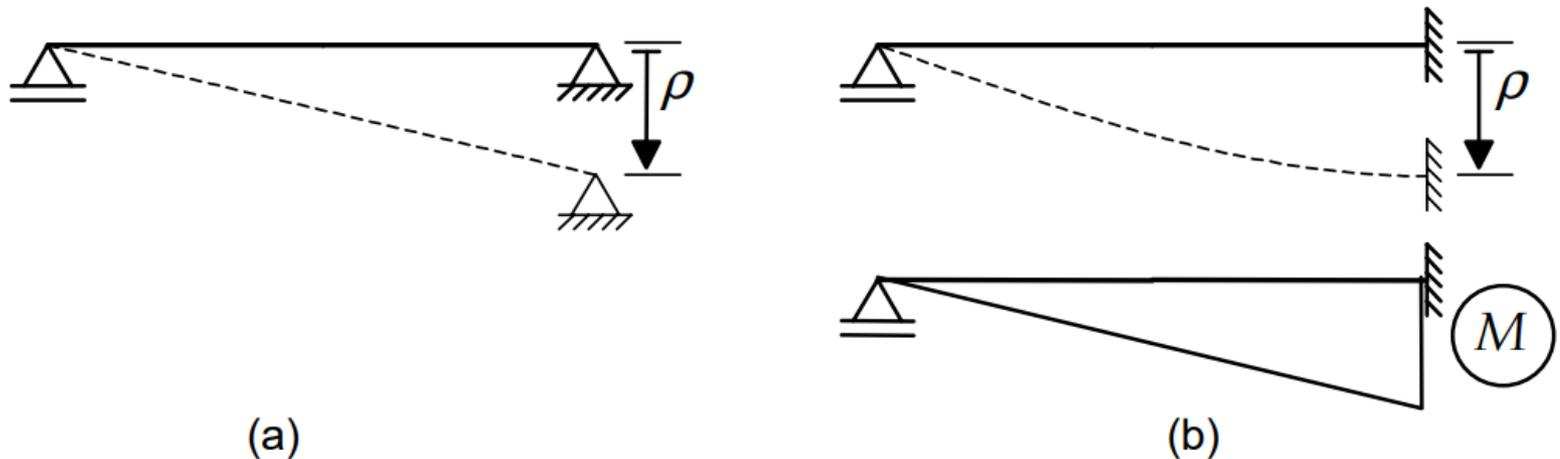
Figura 2.20 – Recalque de apoio em viga isostática e em viga hiperestática.
