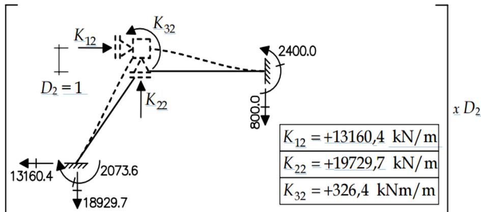
Figura 6.7 – Deslocabilidade  $D_2$  isolada no SH da estrutura da Figura 6.3.
