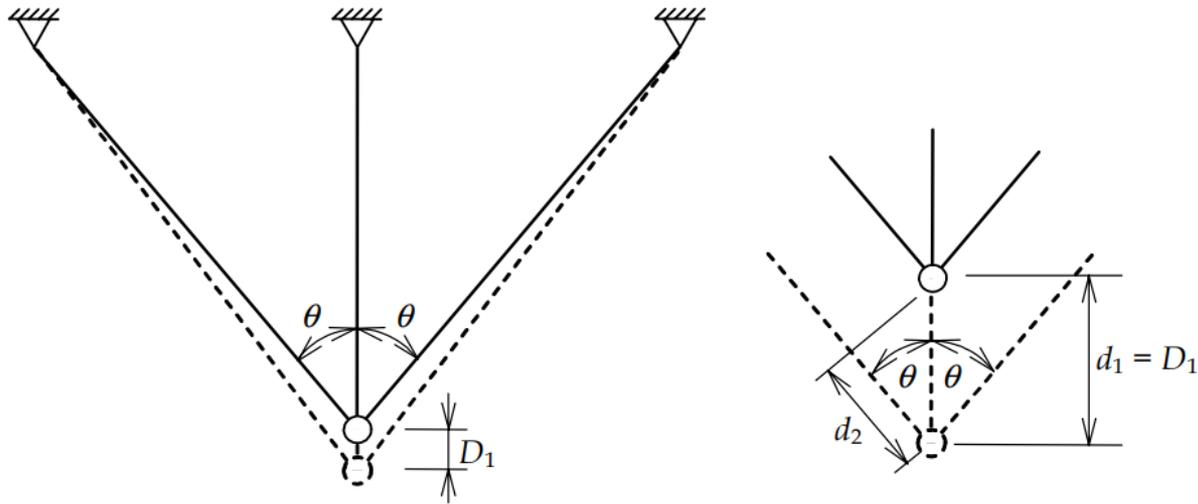
Figura 2.8 – Configuração deformada da estrutura com três barras articuladas.
