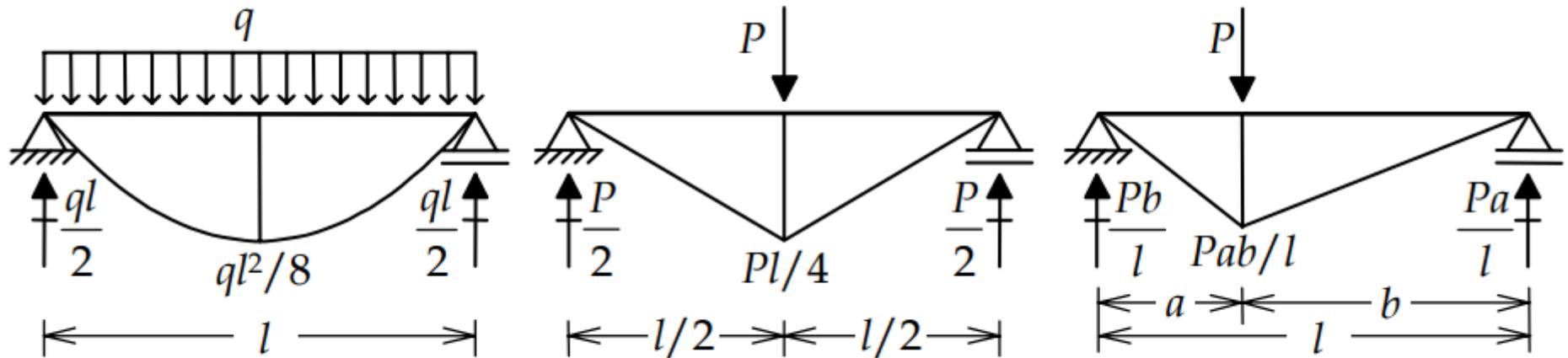
Figura 4.4 – Diagramas de momentos fletores para vigas biapoimadas.
