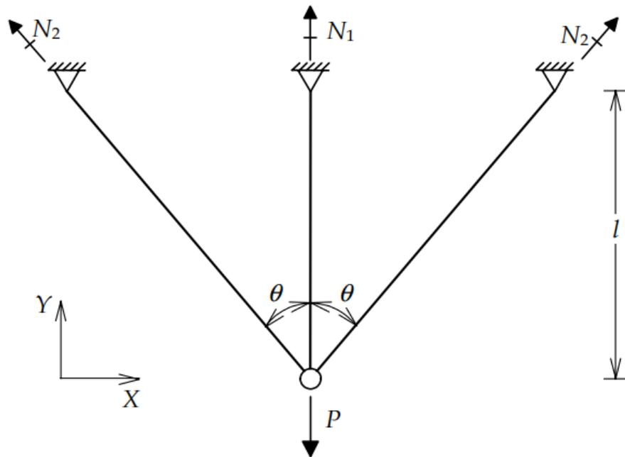
Figura 2.7 – Estrutura com três barras articuladas.
