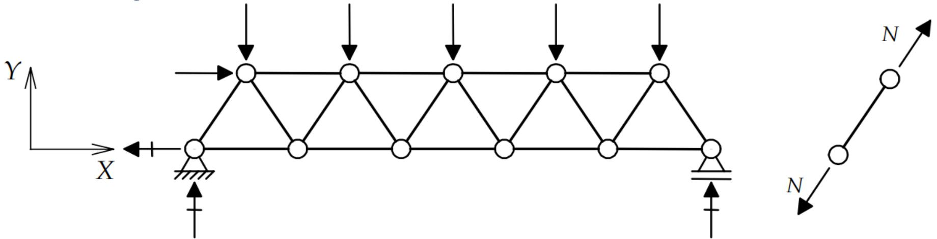
Figura 2.3 – Eixos globais, cargas, reações e esforço interno normal de uma treliça plana.
