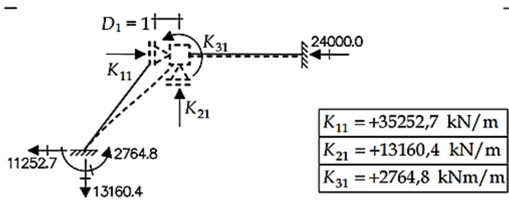
Figura 6.6 – Deslocabilidade  $D_1$  isolada no SH da estrutura da Figura 6.3.
